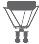
Le Isole Robotizzate - Picker di GPI Group sono macchine composte da un sistema innovativo di presa che utilizza spider robot. Soluzione che permette l'incartonamento di molteplici prodotti mediante l'utilizzo di caricatori a passo o sistemi di visione.
