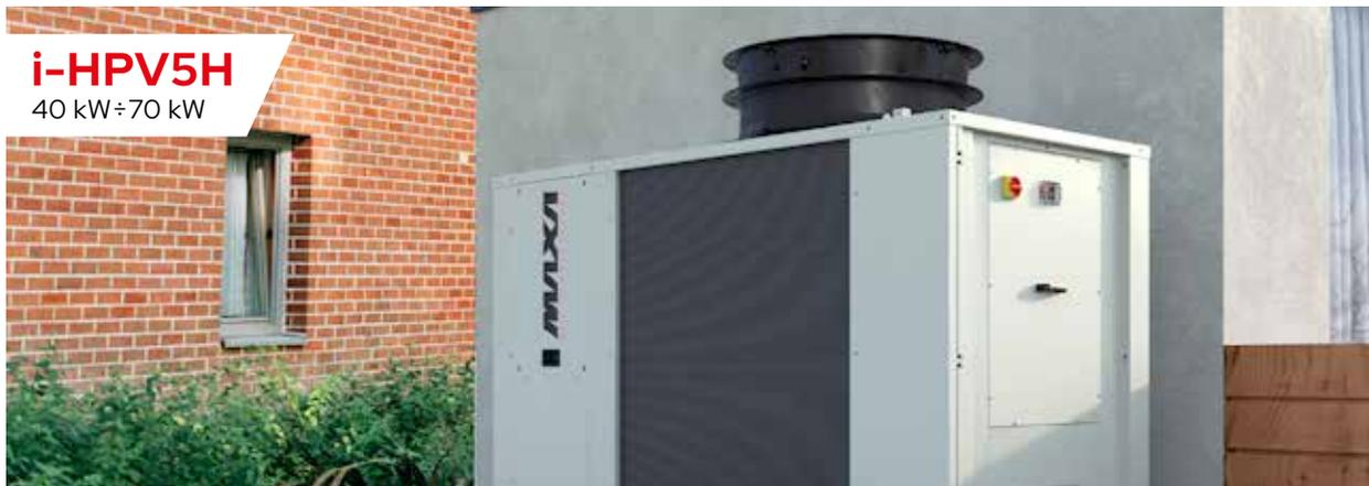
Pompa di calore Aria/Acqua con tecnologia DC Inverter e refrigerante a basso GWP R32 per installazione esterna. La gamma è composta da 4 modelli con compressori DC inverter del tipo ermetico scroll espressamente progettati per funzionamento con R32. Il ventilatore è di tipo assiale con pale a profilo alare, appositamente sagomato per aumentare l'efficienza e ridurre la rumorosità con motore elettrico pilotato in modulazione con motore brushless EC direttamente accoppiato.
