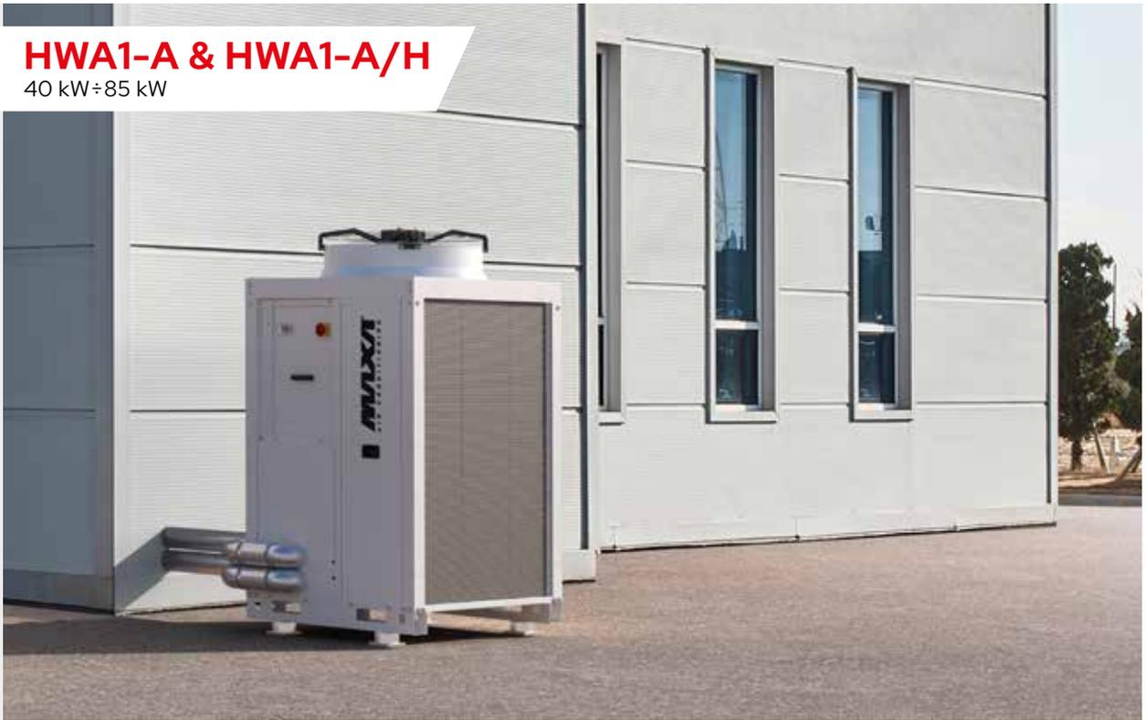
La gamma di chiller e di pompe di calore reversibili aria/acqua della serie HWA1 nelle taglie dai 40 kW agli 85 kW utilizza compressori Scroll a giri fissi, un ventilatore assiale sia del tipo AC che EC a giri variabili (in base alle richieste), ed uno scambiatore a piastre ad alte prestazioni.
